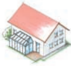
Tetto spiovente con falda laterale inclinata.
