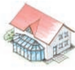
Tetto spiovente - poligono sui due lati.
